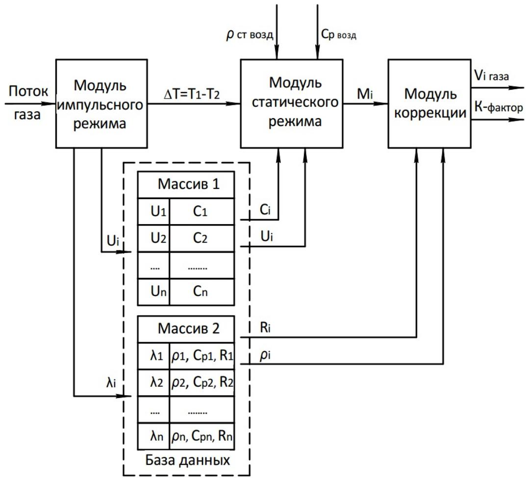
Рисунок 4 – Структурная схема алгоритма работы датчика
