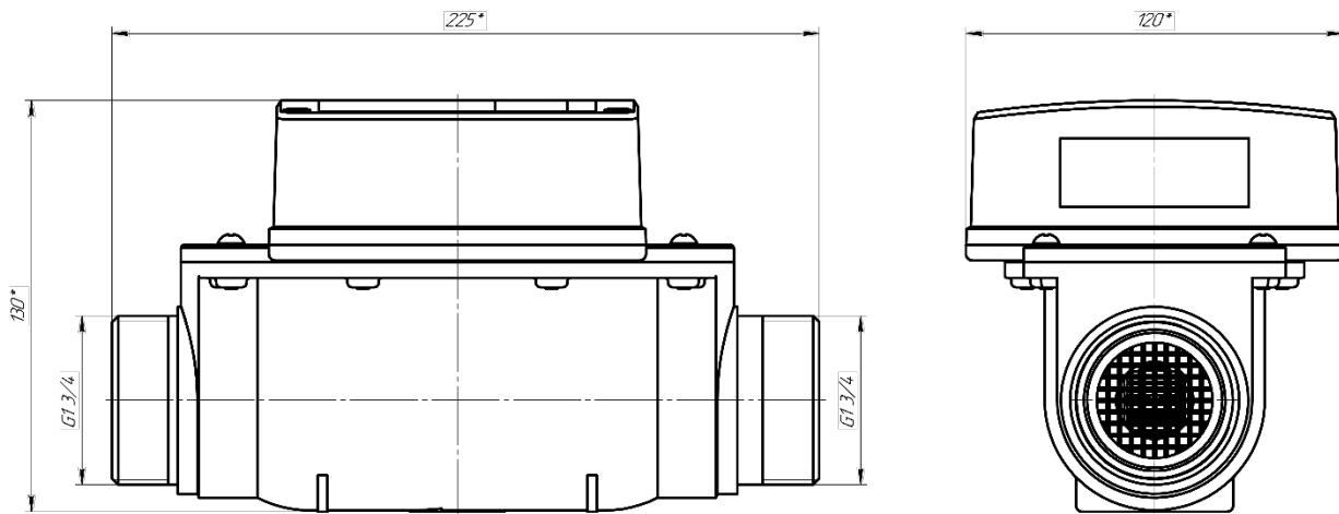
Рисунок 2 – Габариты счетчика газа СМТ-Смарт G10
