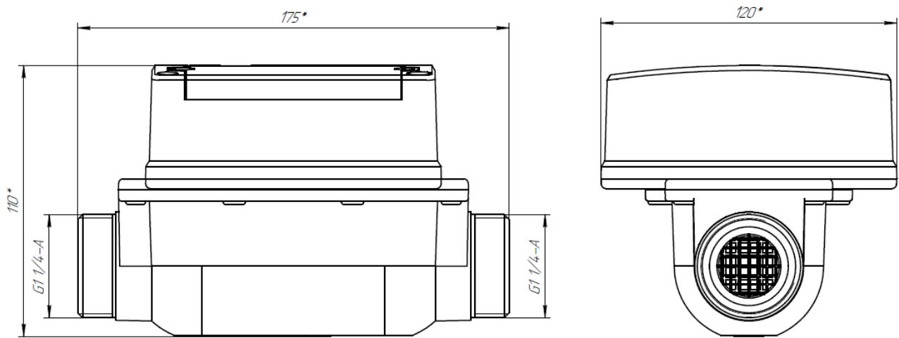
Рисунок 1 – Габариты счетчика газа СМТ-Смарт G4, G6
