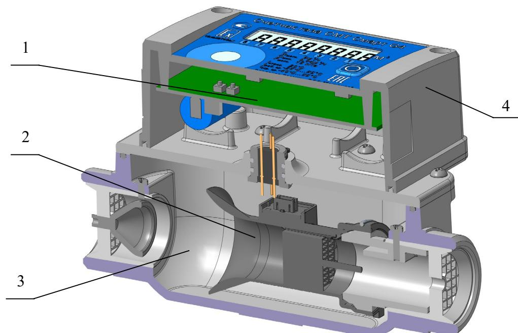
Рисунок 1 – Конструкция счетчика
