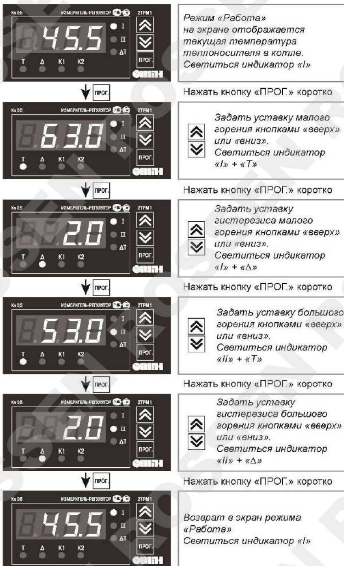
Рисунок 21. Изменение уставок малого и большого горения котла
