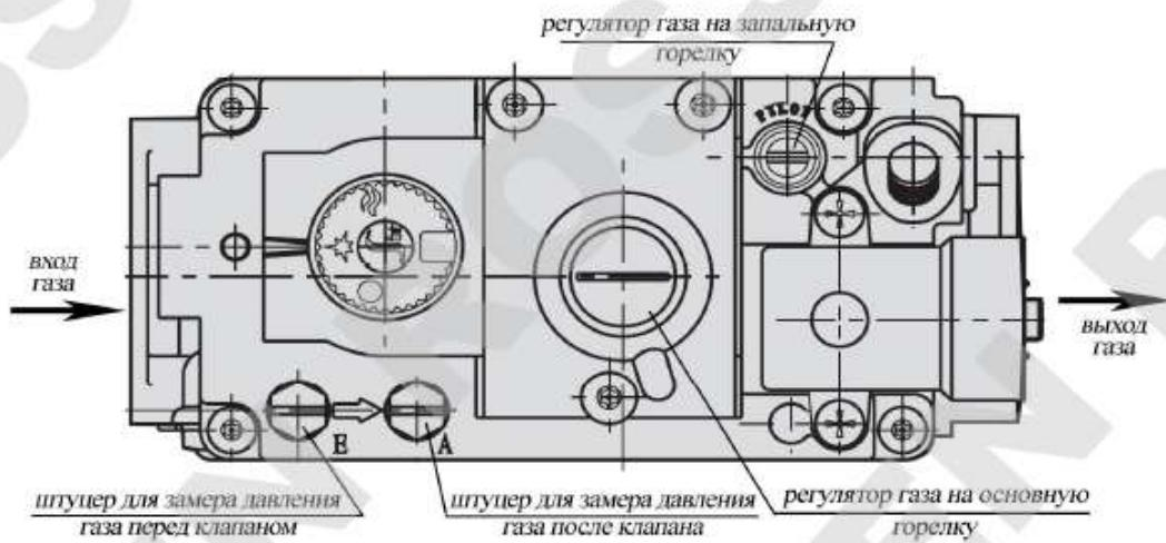
Рисунок – 7. Регулировка газового клапан NOVA 820, вид сверху
