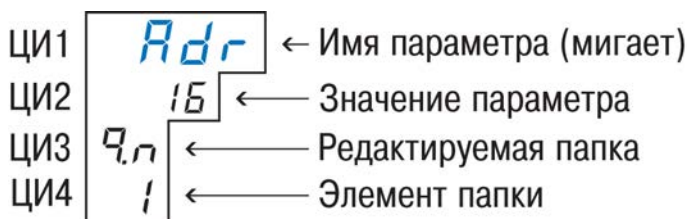
Рисунок 12.3 – Показания цифровых индикаторов при задании параметров
