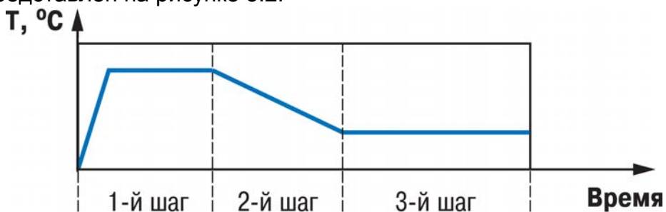
Рисунок 3.2 – Пример Программы технолога для ТРМ151
