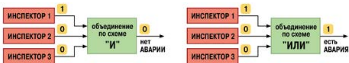
Рисунок 3.21 - Логика принятия решения об аварии
