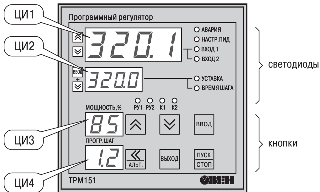
Рисунок 6.1 – Лицевая панель прибора
