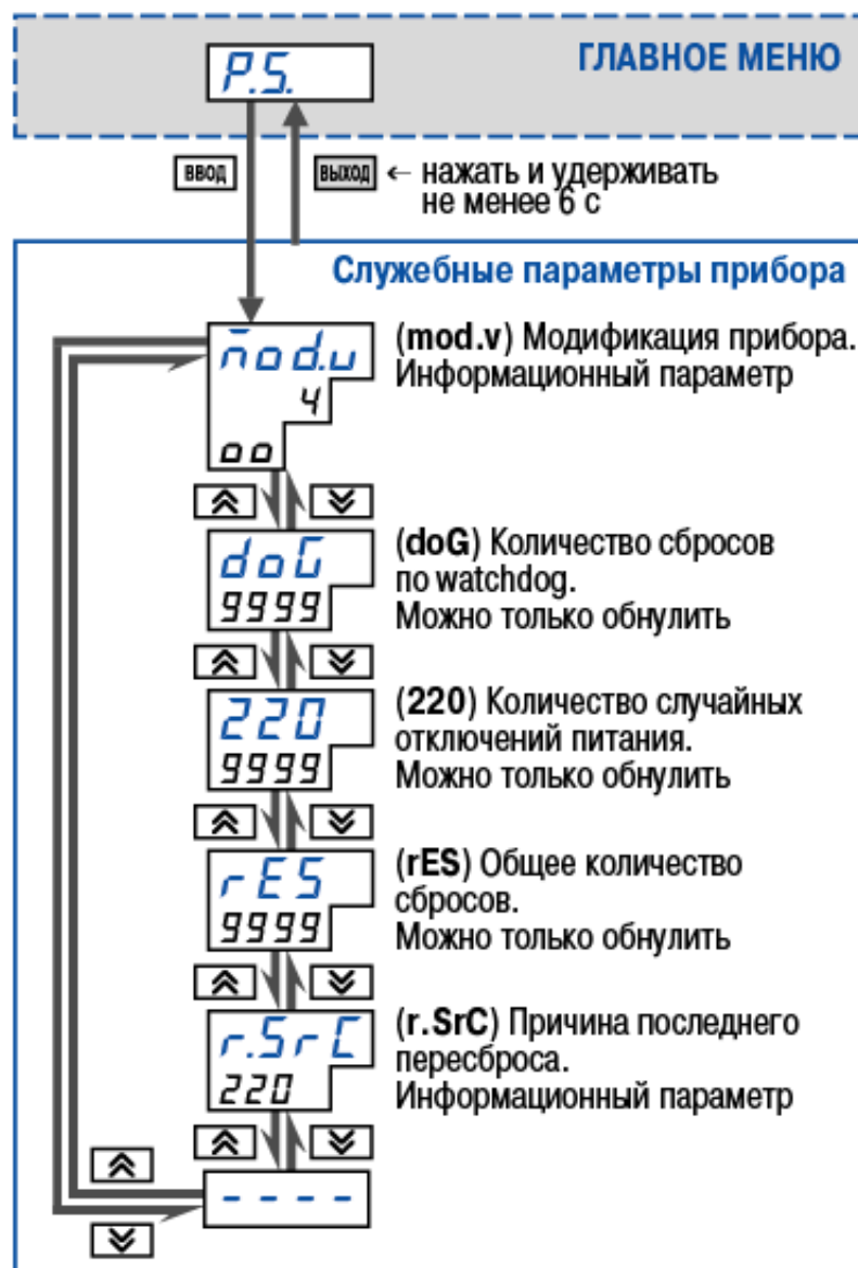
Рисунок 12.28 - Схема задания службных параметров
