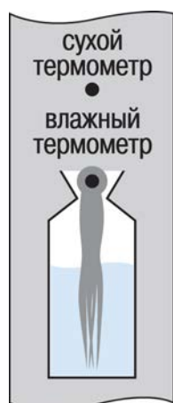
Рисунок К.3 – Форма резервуара с «бутылочным горлом»
