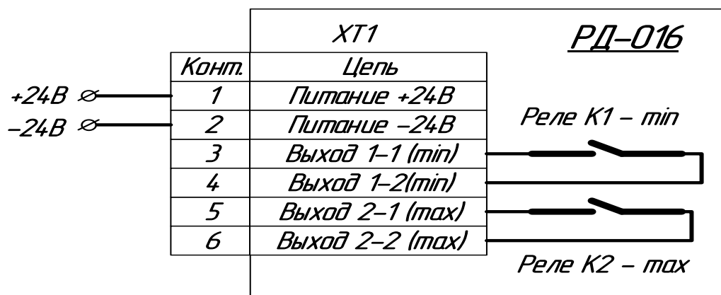
Рис.3а. Распределение цепей выходной колодки ХТ1 реле РД-016 (вариант 24В).
